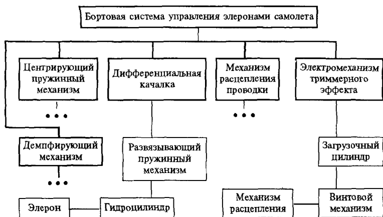
Рис. 3.2.7. Фрагмент технической декомпозиции бортовой системы управления элеронами
