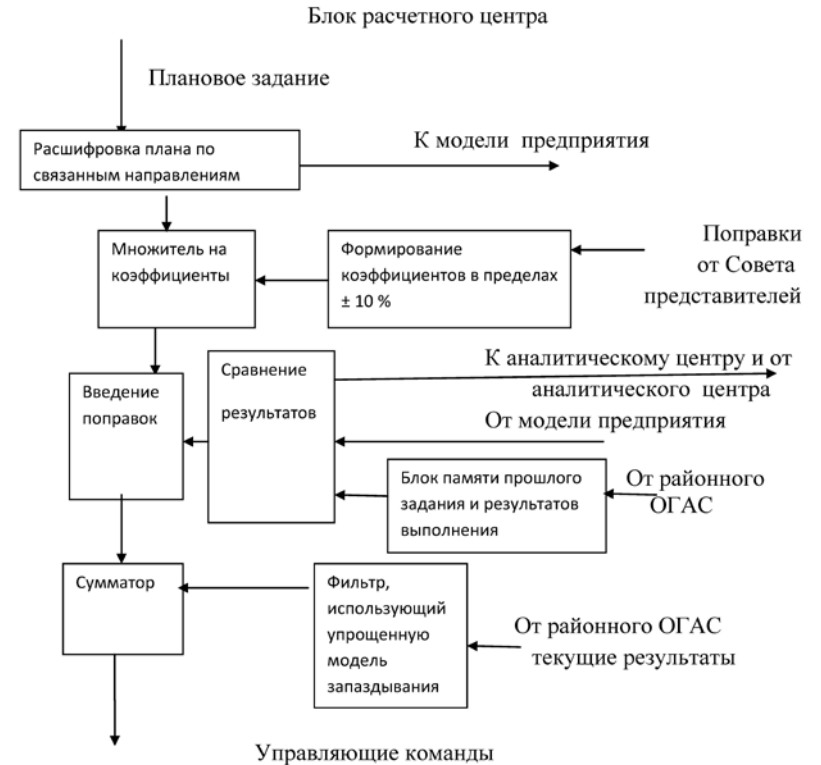
Рис. 2. Структура блока районного расчетного центра
